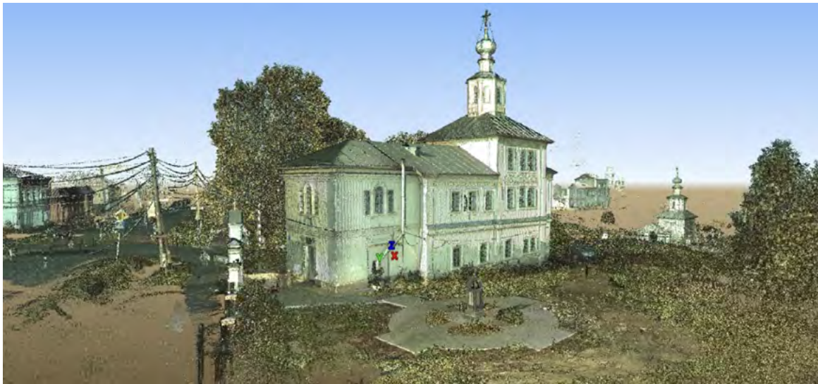
Рис. 2. Пример облака точек, полученного с импульсного наземного лазерного сканера Leica ScanStation C10. Церковь Успения Пресвятой Богородицы в г. Чердыни Пермского края. Работа выполнена в 2018 году кафедрой архитектуры и урбанистики строительного факультета ПНИПУ с участием А.А. Шамариной
