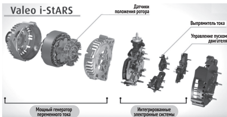
Рис. В.2. Высокопроизводительный реверсивный стартер Valeo i-StARS в разобранном виде [17]
