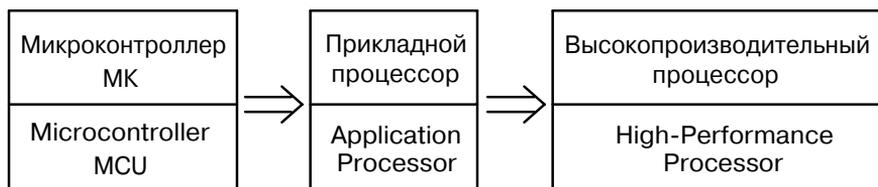
**Рис. 1.3.** Иерархия процессорных устройств
