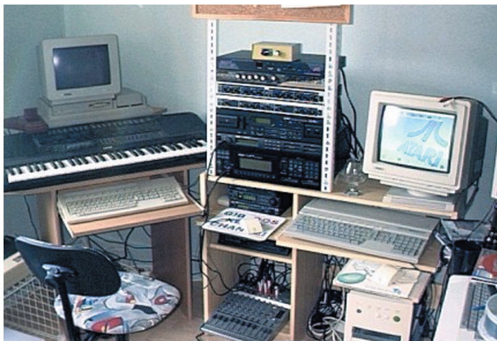
Рис. 2. Домашняя студия конца 1980-х — начала 1990-х. В центре — рэковый шкаф с отдельными приборами для записи, обработки и коммутации звуковых сигналов
