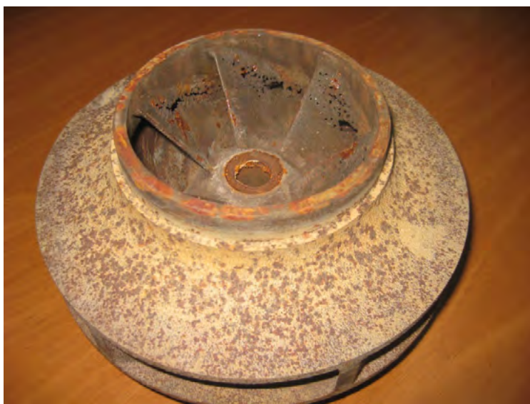
Рис. 1.2. Разрушение лопастного насоса из-за процесса кавитации
