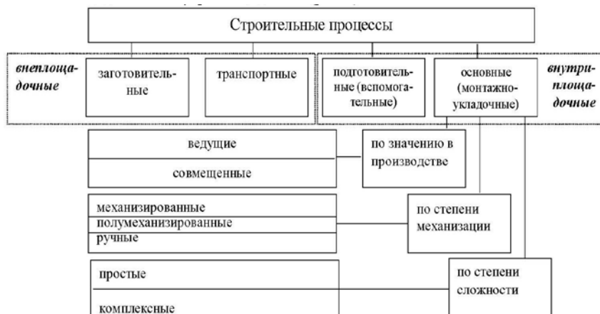
Рис. 1.1. Виды строительных процессов
