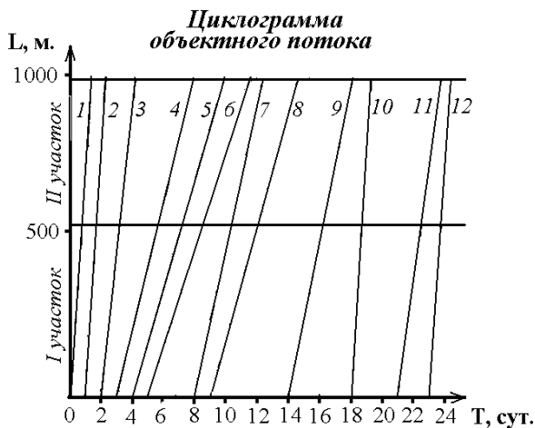
Рис. 1.3. Пример циклограммы поточного строительства трубопровода
