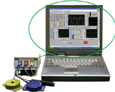
Понятно, что изменение лицевой панели прибора, например добавление еще одной лампочки или ручки управления, – довольно долгое и трудоемкое занятие. А на экране монитора можно легко и быстро менять элементы, добавлять их или убирать, изменять дизайн.
