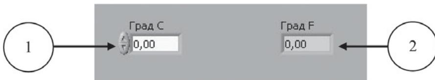
1 – цифровой элемент управления; 2 – цифровой элемент отображения
