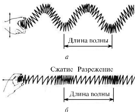
Рис. 1.2. Упругая волна в пружине: а — поперечная волна; б — продольная волна
