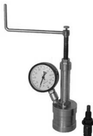
Рис. 1.8. Прибор ПИБ для испытания бетона методом отрыва со скалыванием
