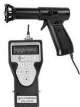
Рис. 1.4. Прибор ИПС-МГ4.03 для испытания бетона методом ударного импульса
