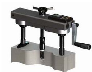
Рис. 1.9. Прибор ОНИКС-ОС для испытания бетона методом отрыва со скалыванием и методом отрыва стальных дисков
