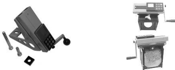
Рис. 1.6. Прибор ОНИКС-СР для испытания бетона методом скалывания ребра
