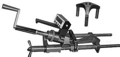
Рис. 1.10. Приборы ПОС-30МГ4 и ПОС-50МГ4 для испытания бетона методом отрыва со скалыванием, методом скалывания ребра и методом отрыва стальных дисков
