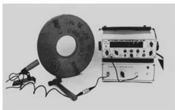
Рис. 10 Прибор «Звук 202-02» для контроля твердости высокопористых кругов акустическим методом
