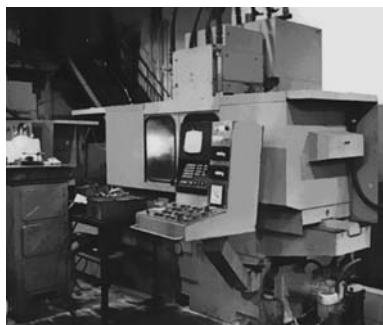
Рис. 4 Специальный плоскошлифовальный полуавтомат с ЧПУ для глубинного шлифования модели ЛШ-220
