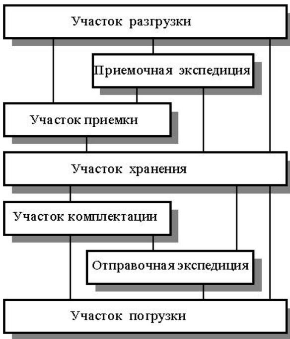
*Рис. 1.* Схема материального потока на торговой оптовой базе
