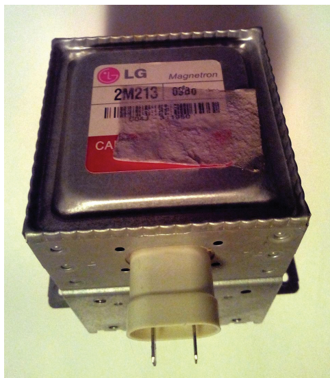
Рис. 1.11. Внешний вид популярного магнетрона типа 2M213-09F
