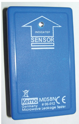
Рис. 1.8. Внешний вид простого светодиодного индикатора СВЧ-излучения
