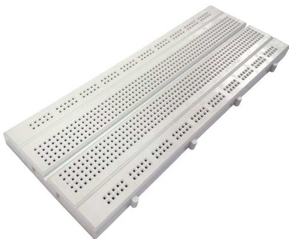
Рис. В.1. Беспаячная макетная плата
