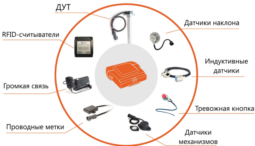
Рис. 1.5. Схема взаимодействия устройства с различными электронными датчиками, устанавливать которые на конкретном автомобиле можно опционально
