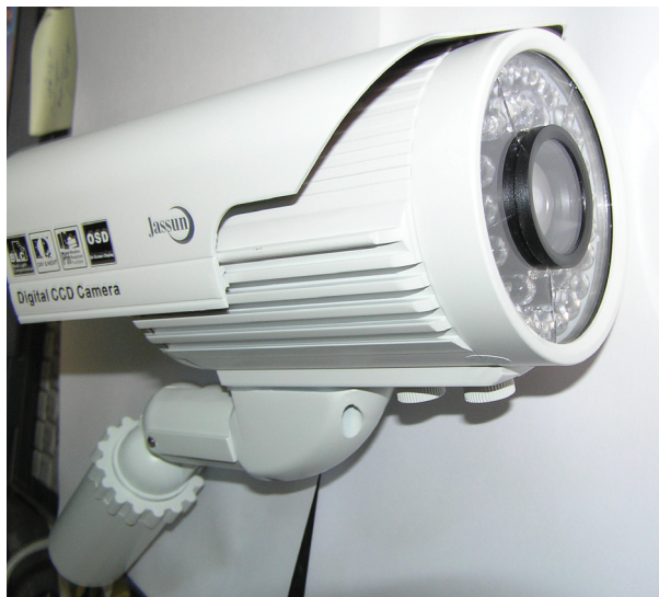
Рис. 1.5. Внешний вид популярной видеокамеры для стационарной установки модели JSC-XV540IR
