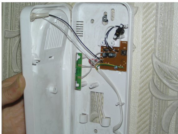
Рис. 1.4. Вид на внутренности аудиодомофона
