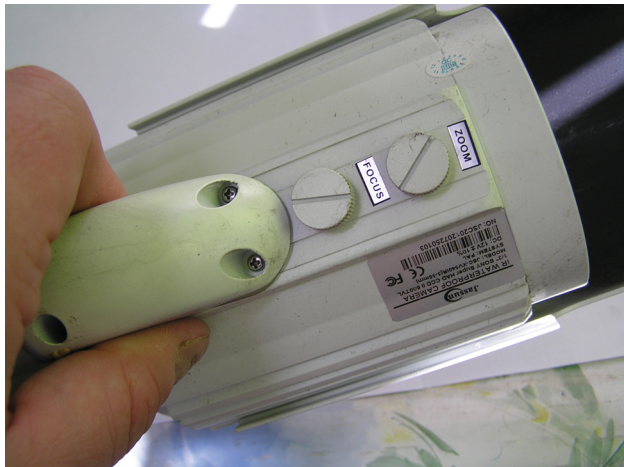
Рис. 1.10. Вид на органы «точной» настройки уличной видеокамеры
