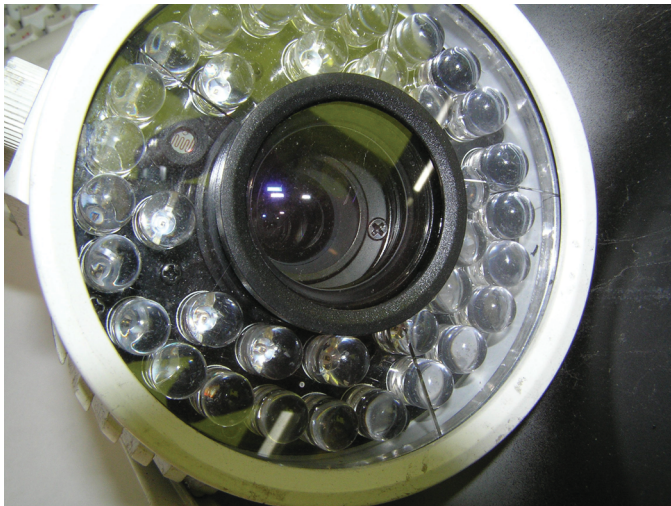
Рис. 1.6. Вид на треснувшее стекло перед объективом
