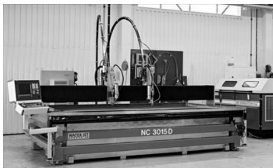
Рис. 2.1. Типовая конструкция установки гидроабразивной резки с рабочими головками, расположенными на траверсе
