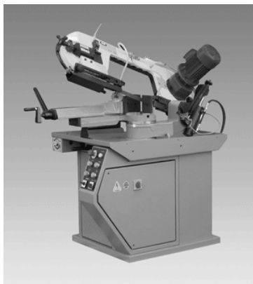
Рис. 1.1. Ленточнопильный станок с маятниковым расположением пильной рамы
