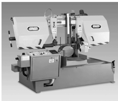
Рис. 1.2. Ленточнопильный станок с консольным расположением пильной рамы
