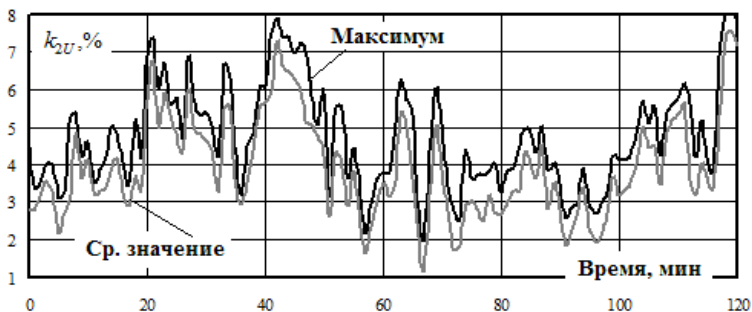
Рис. 1.11. Зависимость коэффициента несимметрии по обратной последовательности от времени
