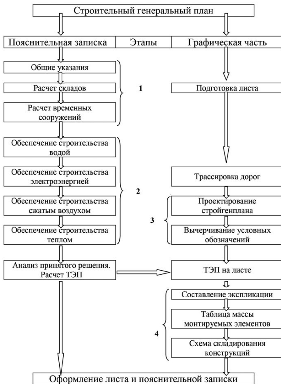
Рис. 1.1. Последовательность разработки строительного генерального плана
