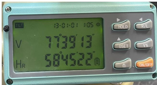
Рис. 7. Изображение дисплея и клавиатуры теодолита
