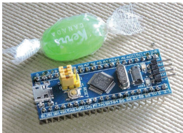
Рис. 1.1. Печатная плата STM32F103C8T6 с припаянными контактными разъемами (Blue Pill)
