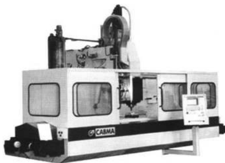
Рис. В.6 Современный фрезерный станок с ЧПУ модели ФП27ВС3
