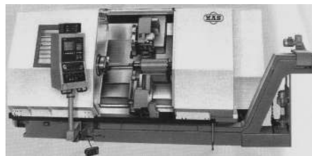
Рис. В.5 Современный токарно-центровой станок с ЧПУ модели SPU20
