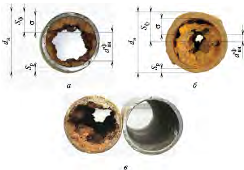
Рис. 1.1. Фрагмент внутренних отложений на стенках: а — металлических водопроводных труб; б — напорных канализационных коллекторов; в — металлических сетей теплоснабжения
