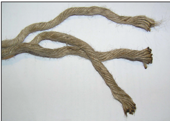
Рис. 1.10. Джутовый канат в расплетенном состоянии
