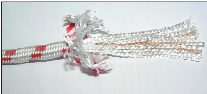
Рис. 1.7. Канат полиамидный ПАТ ГОСТ 30055–93 в расплетенном состоянии
