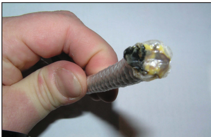
Рис. 1.8. Иллюстрация оплаивания жил каната огнем
