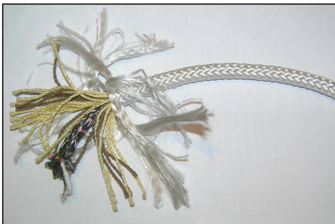
Рис. 1.3. Внешний вид веревки на основе полипропилена в расплетенном состоянии
