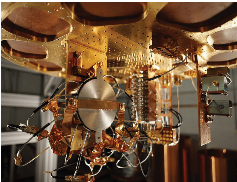
Прототип квантового компьютера Google. Согласно заявлению компании – квантовый процессор Sycamore, оперирующий 54 квантовыми битами, за 200 секунд выполняет вычисление, которое у самого мощного компьютера заняло бы 10 тысяч лет. Фото: Erik Lucero/ Google
