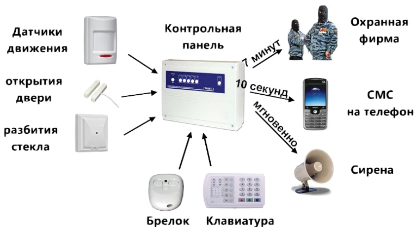
Рис. 1.1. Блок-схема центрального пульта охраны и других ее составляющих
