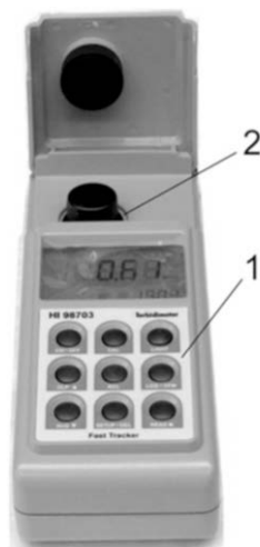
Рис. 4.1. Внешний вид экспериментального оборудования: 1 — нефелометр; 2 — измерительное отделение
